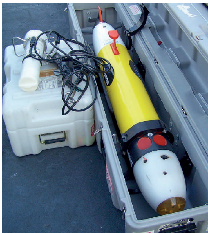
Il REMUS 100 è un veicolo sottomarino autonomo (AUV) progettato per operare fino a 100 metri di profondità.
