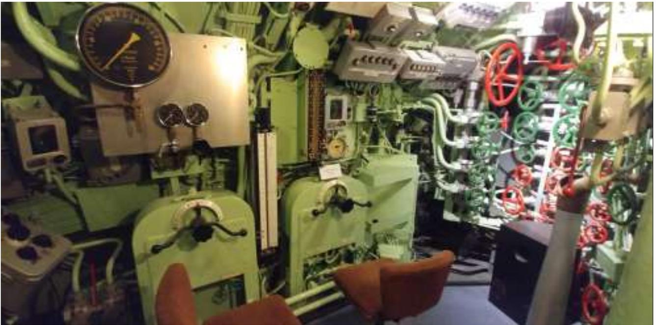
*Il posto degli addetti al controllo della profondità in camera di manovra, con la cloche di tipo aeronautico per il governo dei timoni di immersione con la scritta "a scendere" a sinistra e "a salire" a destra. La spaziosità dell'ambiente, di norma inconcepibile nei battelli dell'epoca, è notevole.*
