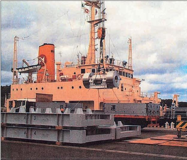
Caricamento del combustibile (tuttavia ancora spento) a bordo del progetto giapponese *Mutsu*, nel porto di Sekinehama
