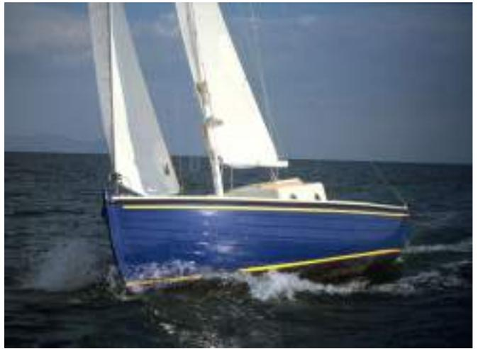
Una volta in mare la barca ha dimostrato il suo pedigree. Con un motore 4 tempi da 8 HP, a mezza potenza ha raggiunto una velocità di 6,5 nodi con un consumo orario inferiore al litro e mezzo.
