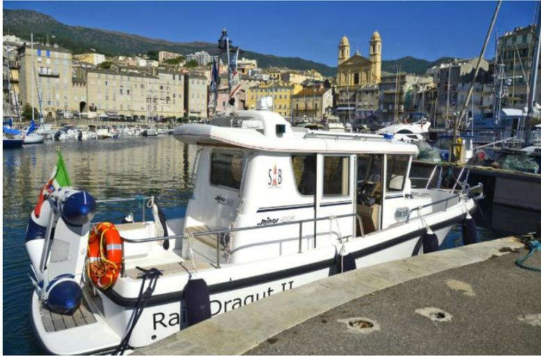
Il Rais Dragut II è una [Minor Offshore 25 \(ora Sargoboats\)](#). La barca è costruita in Finlandia e rientra in una tipologia di imbarcazioni caratterizzate da un ponte ad un unico livello (walkaround) e da una grande versatilità di utilizzo.
