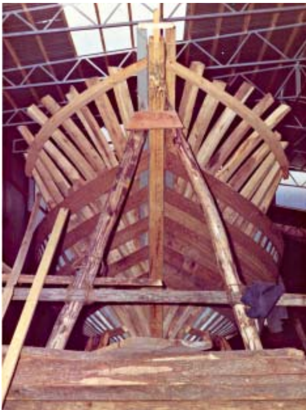
Una rara immagine del San Giuseppe Due sullo scalo di costruzione; lo scafo, particolarmente robusto, aveva l'opera viva in quercia, l'opera viva al trincarino in iroko e la coperta in tek; il dritto di prora era rinforzato da una lastra d'acciaio; in apertura Giovanni Ajmone Cat al rientro ad Anzio, dopo la sua avventura
